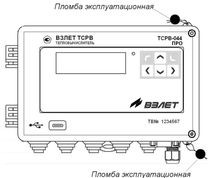
Рис.3. Размещение маркировки и мест пломбирования корпуса ТВ.
